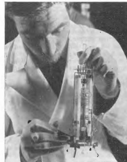
Nella foto si vede un dispositivo proiettore elettronico per un tubo a raggi catodici ad accumulo, comprendente un proiettore scrivente e due proiettori esploratori; nella foto, il proiettore viene ispezionato durante la fabbricazione presso una ditta inglese nell'Inghilterra meridionale.
